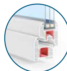
T-Classic Sieben Kammern Rahmenbautiefe von 70 mm
