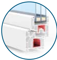
T-Passive Energy Sechs Kammern Rahmenbautiefe von 88 mm
